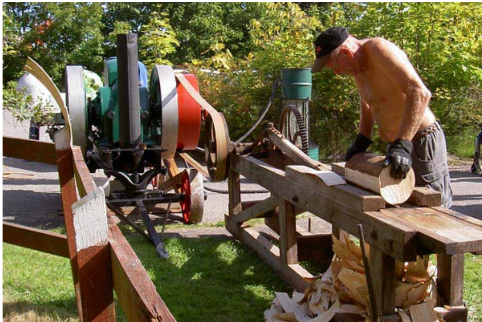
"Sluggo" demonstrerar hur det gick till att tillverka takspån med denna hyvel som drevs av en tändkulemotor.
