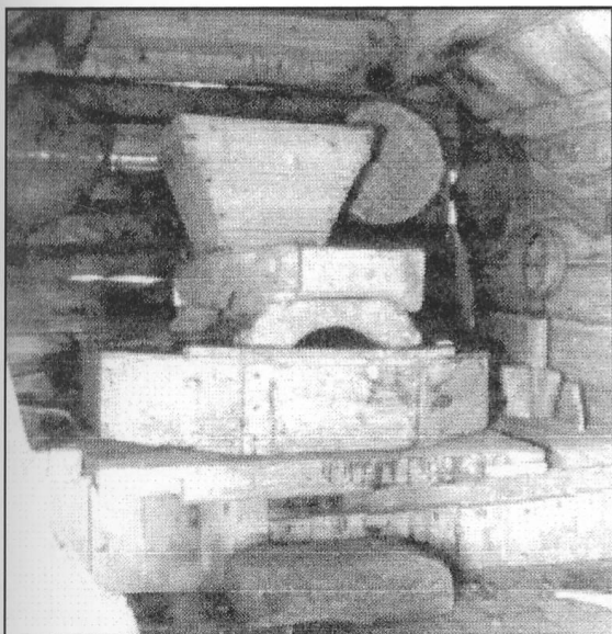
Bild 30 Bossgårdens skvaltkvarn, Ås sn i Halland. Typiskt sydsvenskt kvarnmaskineri med åttkantigt kvarnkar som vilar på den fyrkantiga plankram, vilken omger understenen. På kvarnkaret står kuphästen, som bär upp kvarntratten.
