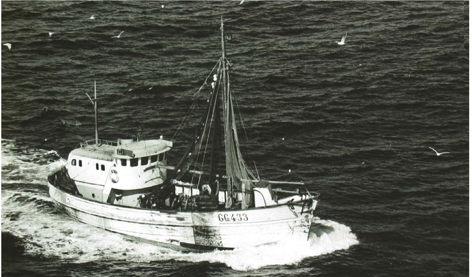
GG 433 Solvåg byggd 1954 på Bergs på Hälsö Br.ton 71,31. L 20,08m B 6,12 D 2,65 m. Motor Bolinder Munktell 2-cyl 220 hk
