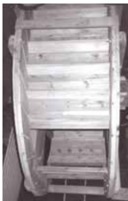
Kvarnen i Skinnemyra är en överfallskvarn, vilket ger den bästa effekten i kvarnens drift jämfört med bröstfalls- och underfallshjul.
