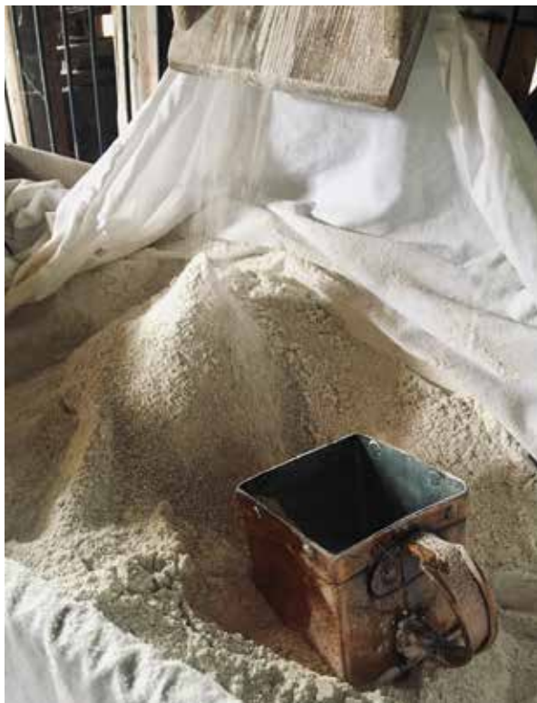
Här den s.k. tudan, det rör av trä som mjölet rinner genom efter kvarnstenarna. På bilden syns också ett tullkvarnsmått av koppar. Foto: Camilla Melin
