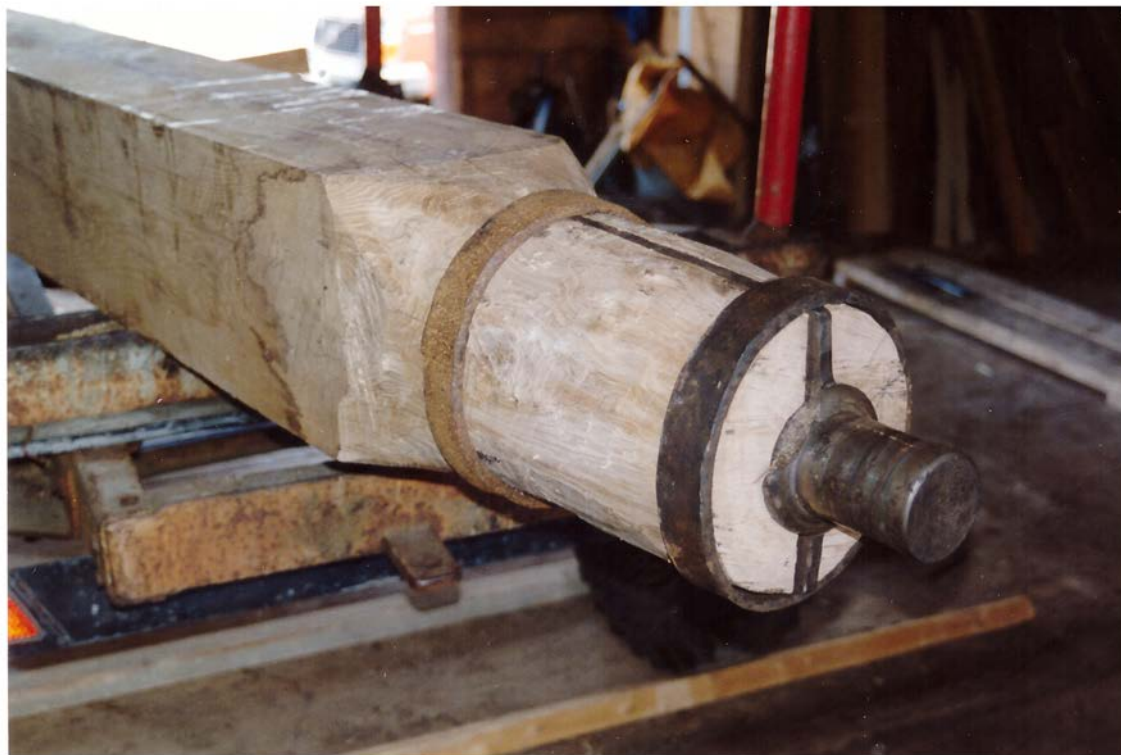
Den ca 800 kilo tunga axeln är här färdig att träs in genom vattenhjulet. Det krävdes stor precision vid tillverkningen.
