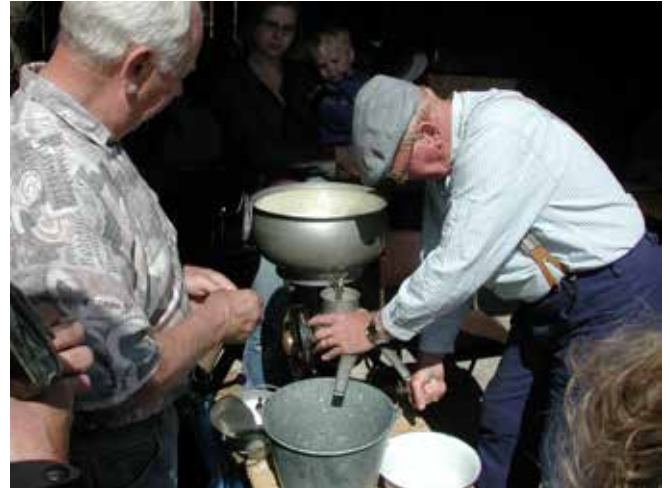
En mycket bra separatormodell konstruerad av Gustaf de Laval. Den vevas för hand med hög utväxling och på kort tid skiljdes grädden från mjölken. Separatoren är försedd med 2 rör som leder ut grädden respektive skummjölken, som är restprodukten vid separationen av grädden Foto: Leif-Åke Lannetoft
