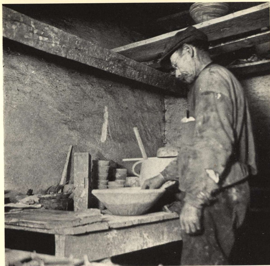
August Cederholm i sin verkstad. Han står just och lagar till våtglasynen. — Nästa bild skall visa hur den hålles på kärlen.
