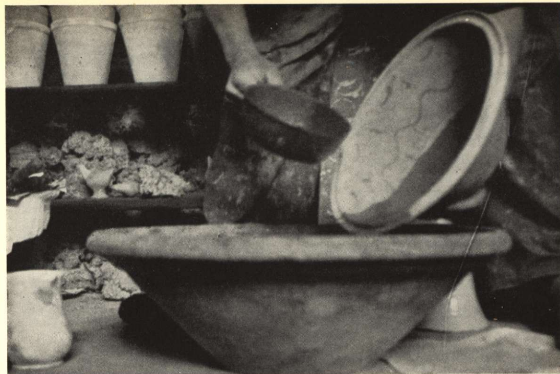
Våtglasering. Över det stora s. k. glasyrfatet sker proceduren. Med en skopa öses den starkt karminröda glasyrvällingen på kärlytan. Nu täcker den all dekor. Vid bränningen förglasas den emellertid och blir genomskinlig.
