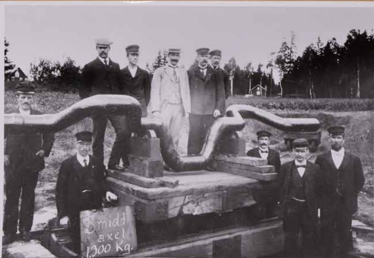
STOLTA YRKESMÄN VID SITT FÄRDIGA ARBETE; Smidd Vevaxel av 150 m.m.rund stålstång avsedd till Blåsmaskin vid Boxholms Bruk, skulle böjas i tre olika faser bildande 120 graders vinkel. Foto år 1904. Från vänster: AUGUST JOHANSSON f.1870 i Ångstugan Bottorp, i Hagstugan 1872-1900, KARL SJÖSTRÖM f.1879 i Fallet I, KARL FREDRIK EKSTRAND f.1865 i Mölltorp, KARL ALMGREN f.1882 i Knista, Förman JOHAN VILHELM FORSLUND f.1868 i Kvistbro, hitkom från Sura 1898, utfl.till Motala 1905, KARL HULTMAN f.1876 i Kvistbro, kom som föregående från Sura 1898; blev Förman utfl.till Karlskoga 1913, DAVID PALM f.1877 i Wiberga, 1887-1900 i Gökbäcken, KARL PETTERSSON f.1870 i S:t Olai, EMANUEL PETTERSSON f.1879 i Lotorp, samt "Stålräckarn" CARL GUSTAF CARLSSON f.1858 i Ö.Vingåker. Husen i bakgrunden till v.Fallet I "Högby" samt till h. Fallet III "Grålus".
