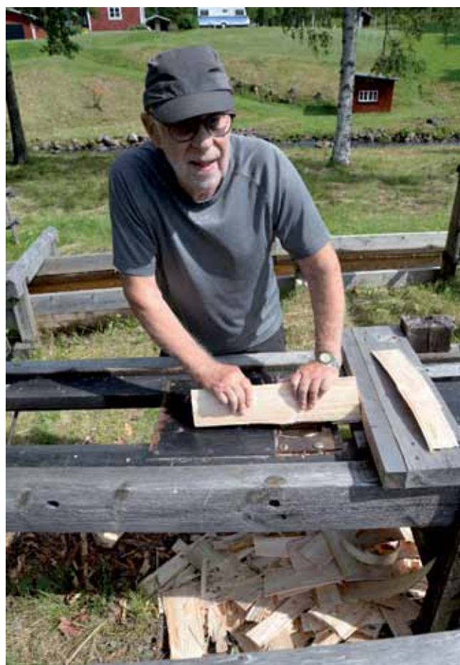
Roland Öhman visade hur man med spånhyveln tillverkar takspån med vattenhjulet som kraftkälla.
