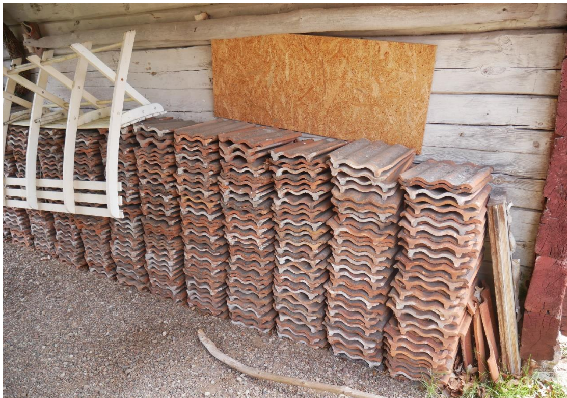
Det finns gott om trekupigt tegel som kan användas för att komplettera vid takomläggningarna.
