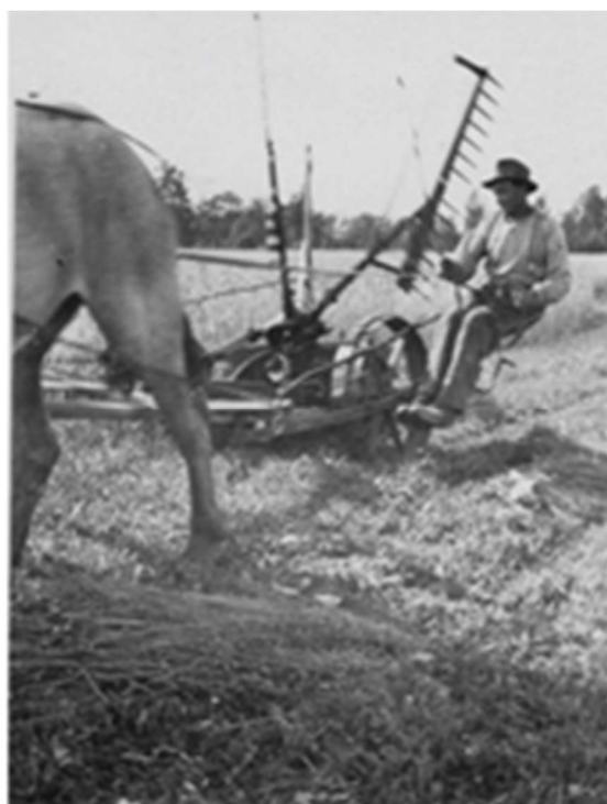
På gården fanns på 1930-talet en självavläggare som lade högar av säden lagom att binda en nek. Hästarna Freja och Docka drog. På bilden till vänster binder faster Anna säden i bakgrunden. David kör.
