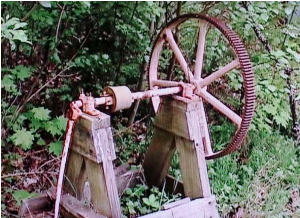
Ture på Sjöbos trampslip. Stenen nedsliten till 10 cm..
