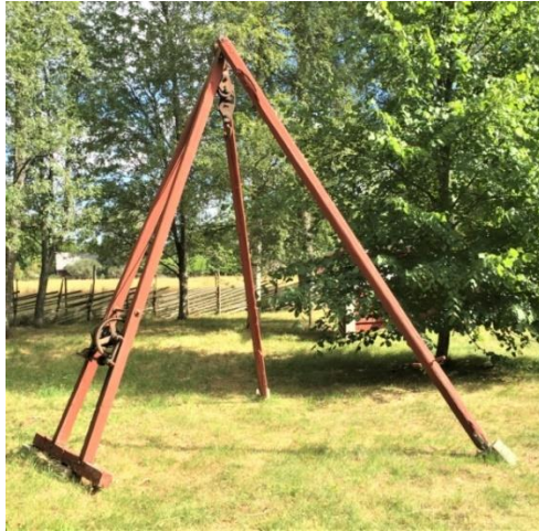
Trefot, även kallad stenhjätte eller stenpär. Användes för att flytta bort stora stenblock som inte kunde brytas upp med spett. Stenhjätten står på Väckelsångs hembygdsgård.
