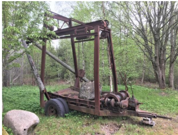
Stenvagn, för borttagning av stora block från åkrarna. Den här står på hembygdsgården i Kalvsvik.
