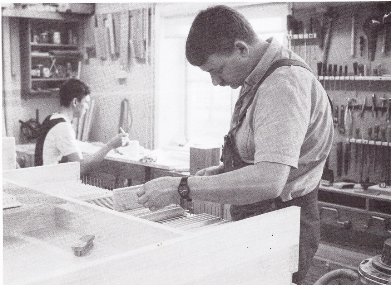
Hösten 1987 pågår arbeten med en orgel till Hosjö kyrka i Dalarna. Vid tillverkningen av väderlådorna arbetar Lars-Åke Olsson (i förgrunden) och Johannes Ringström.
