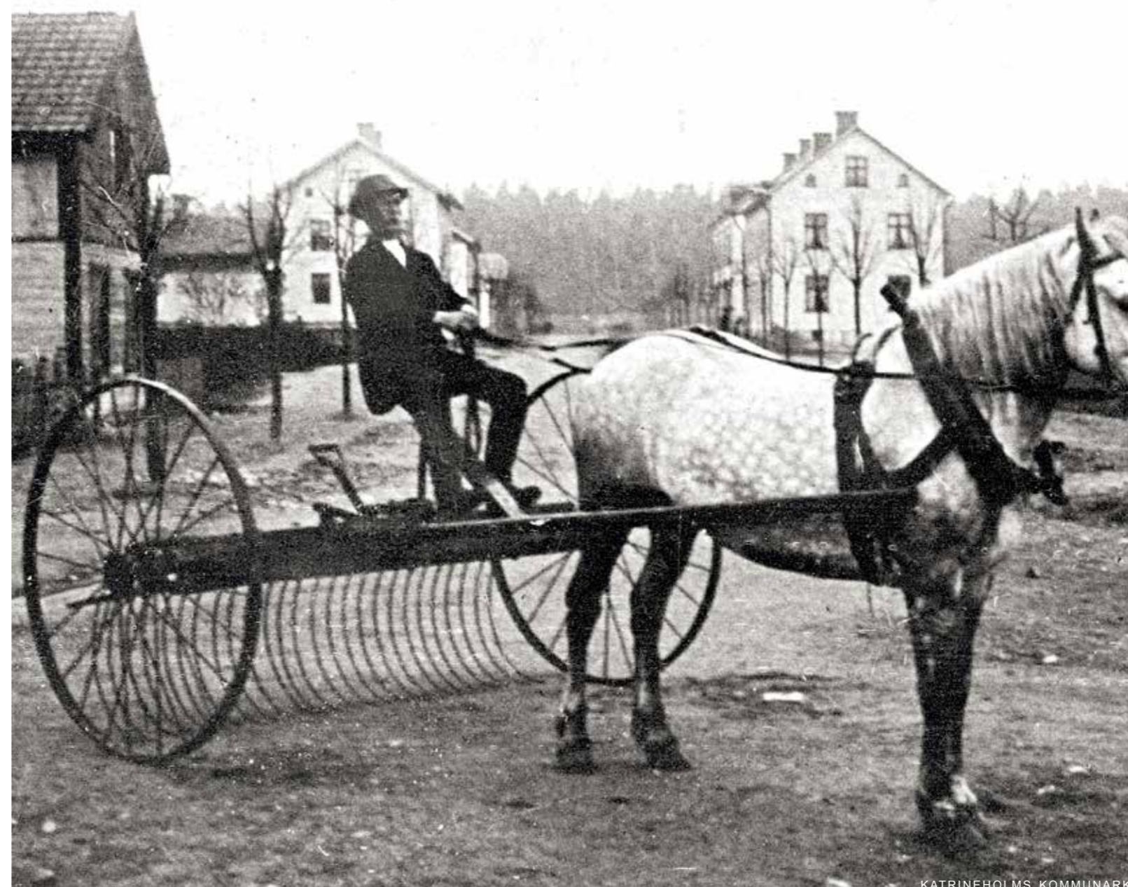
Grönkvist konstruerade en hästdragen räfsa där pinnarna drogs upp automatiskt när de stötte på stenar eller andra hinder. Den kallades balansräfsan och blev en stor artikel både i Sverige och utomlands. Den tillverkades av Grönkvists Mekaniska Verkstad och såldes av Kullberg & Co.
