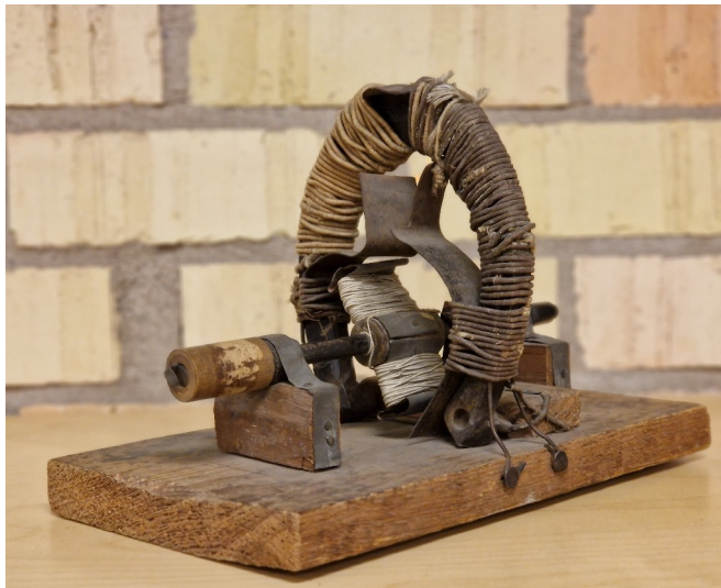
En elmotor med en lindad hästsko som stator. Användes 2022 som Wenströms prototyp i teaterpjäsen Asea – här kommer framtiden! Pjäsen kan ses i digital visning till 2026-04-18. Länk i Västmanlands teaters hemsida.
