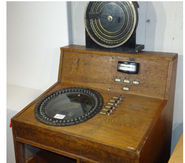
En tidig övervakningsutrustning från 1928. Här bevakade växeltelefonisten i Surahammar den obemannade vattenkraftstationen. Vid larm kontaktades ledningen i Västerås.
