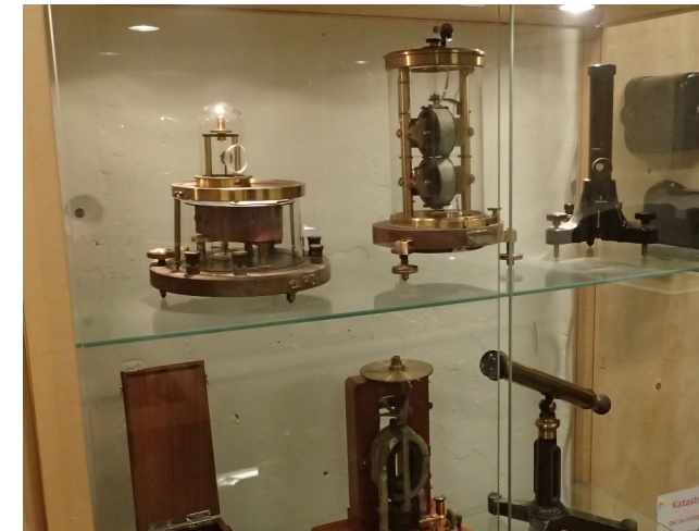
Äldre mätinstrument var ofta tillverkade av mässing och mycket eleganta. På översta hyllan står spegelgalvanometrar som användes för att mäta små strömmar.
