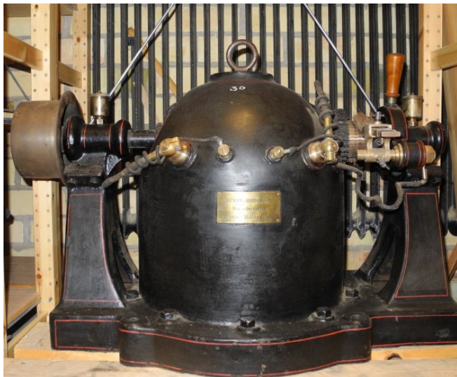
Elektrisk motor tillverkad i Arboga 1886, kallad "Bikupan" efter sin form. Den har tillverkningsnummer 100. Andra maskiner som Jonas Wenström konstruerade kallades: Sköldpaddan, Grytan och Snörilvet efter deras utseende.
