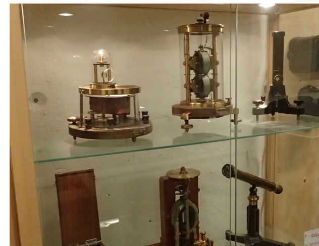
Äldre mätinstrument var ofta tillverkade av mässing och mycket eleganta. På översta hyllan står spegelgalvanometrar som användes för att mäta små strömmar.
