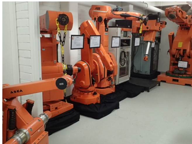
ASEA var pionjär i att tillverka helelektriska industrirobotar. Den första, IRB 6, till vänster, tillverkades i 7 000 exemplar från 1974 till 1991. Därefter kom en lång rad förbättringar, ofta var det styrprogrammet som utvecklades med nya funktioner.
