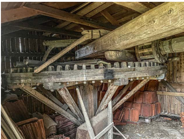
Vandringssringen 3,3 m i diameter. Rörelsen växlas över till den grova träaxeln in till logen, syns uppe i högra hörnet.
