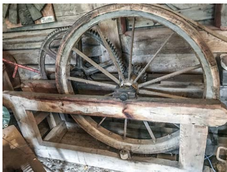
Kuggväxeln. Det vänstra kughjulet är centriskt ansluten till Vandringens axel. Remdriften till tröskan syns i högra delen.
