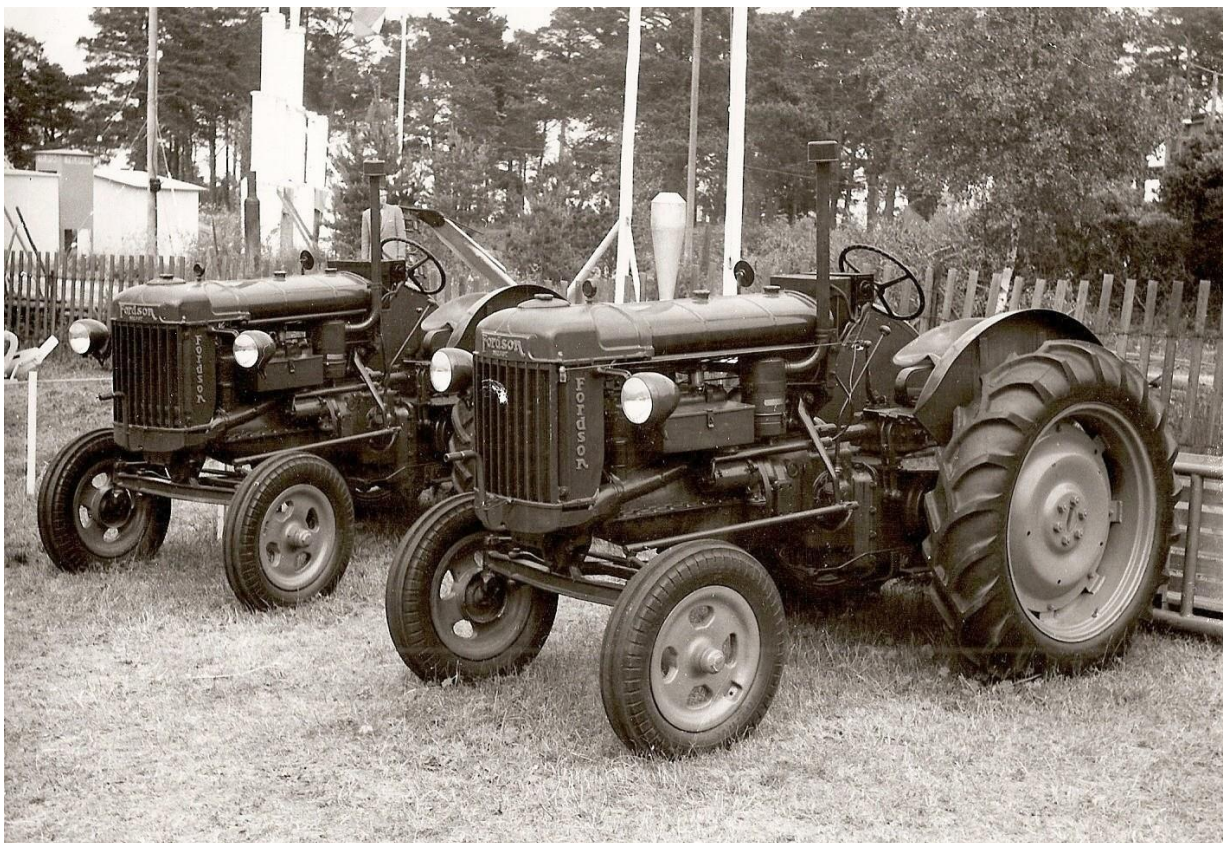
Bilsta Verkstäder medverkade på Öregrundsutställningen 1950. Firman visade upp två Fordsontraktorer av typ "Höglund" för bensin/fotogendrift. Dessa höga traktorer fick snabbt en vid spridning och kunde vid leverans utrustas med lastare.
