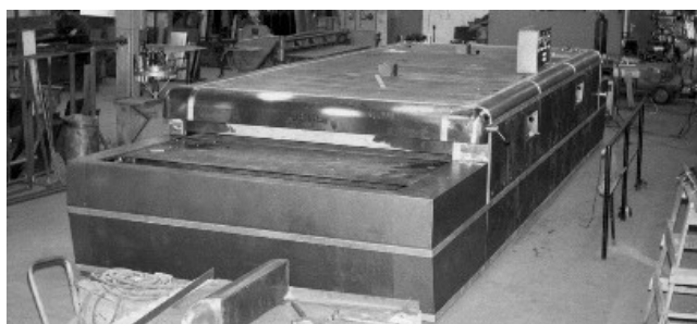
TU – tunnelugn 6m lång, bandets bredd = 2350mm (tillv.år 1955-71)
