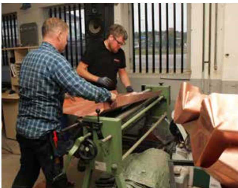
Martin och Anton viker kopparplåtar i plåtslageriet i Tranås. På bilden till höger är de på plats i kyrktornet Frinnyrd och monterar dem.
