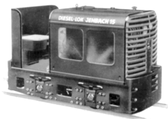
Industriloket JW 15 vägde 3,5 ton och gjorde som mest 8 kilometer i timman. Bild och fakta hämtad på www.kaldaren.net .
