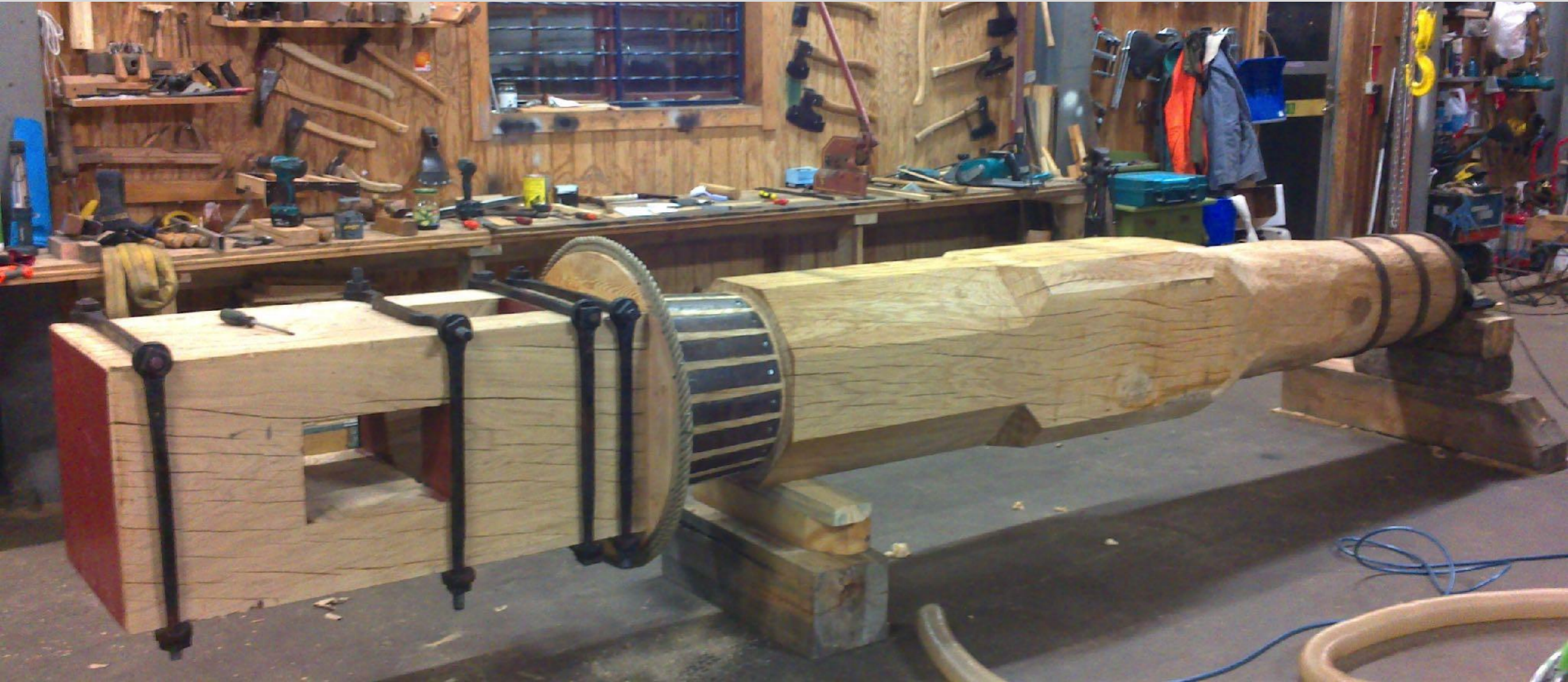
Axeln tillverkades i Traditionsbärarnas verkstad i Forsvik. Alla järn återbrukades igen efter att se renoverats av smeden Julius P.
