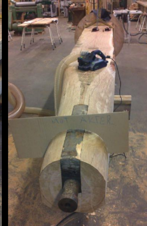
Axeln tillverkades i Traditionsbärarnas verkstad i Forsvik. Alla järn återbrukades igen efter att se renoverats av smeden Julius P.
