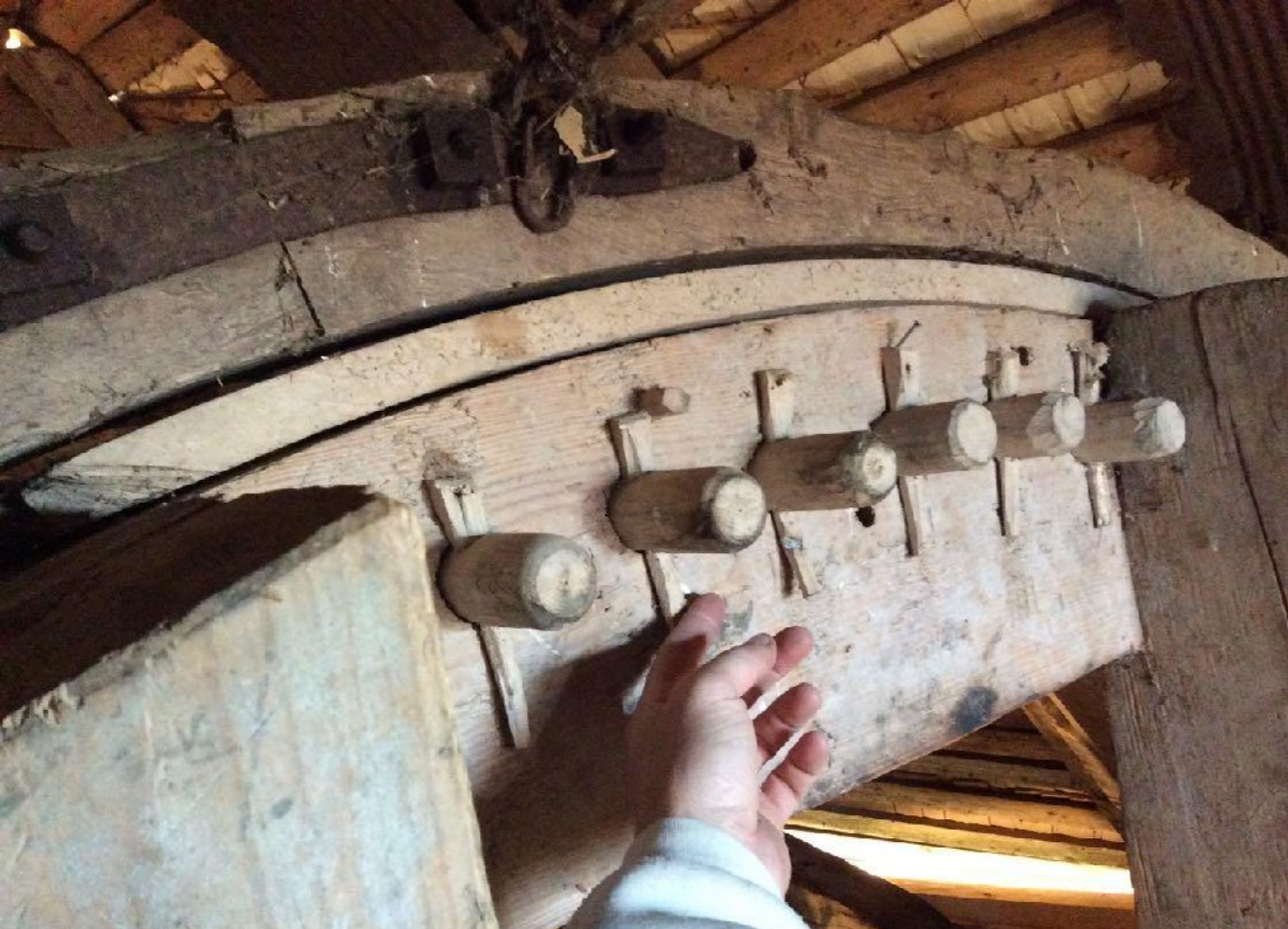
Kvarnmekanismen justerades för testkörning med den lilla gröpestenen för fodermjöl. Testkörning utfördes under våren 2017.
