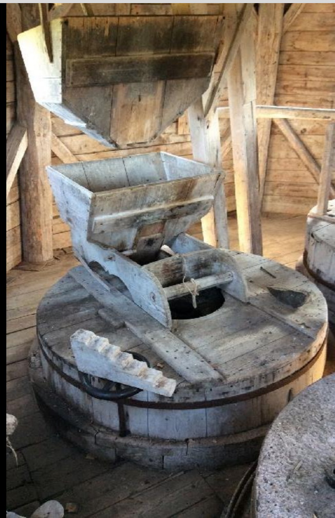
Kvarnmekanismen justerades för testkörning med den lilla gröpestenen för fodermjöl. Testkörning utfördes under våren 2017.
