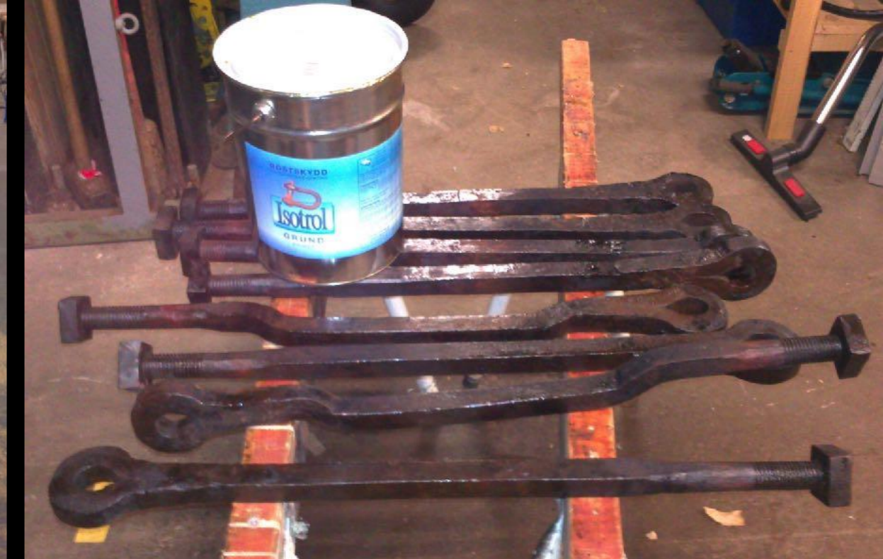
Axeln tillverkades i Traditionsbärarnas verkstad i Forsvik. Alla järn återbrukades igen efter att se renoverats av smeden Julius P.
