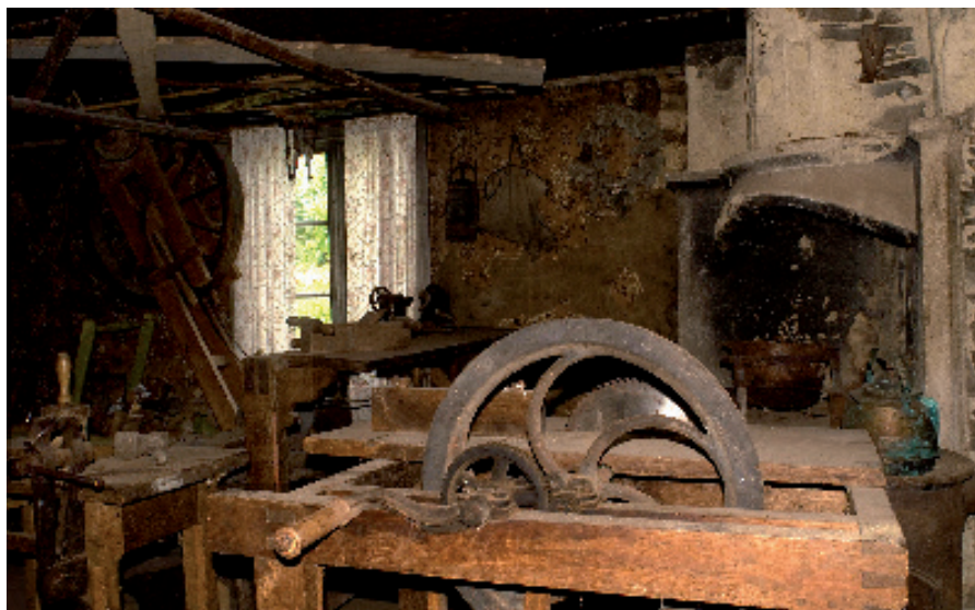
Alla ekmöblerna gjordes med hjälp av dessa verktyg. Hjulet i taket drev svarven som han formade träet med. Trampa svarven och elda i öppna spisen ville han gärna ha hjälp med. I förgrunden den handdrivna cirkelsågen och skruvstäd för att slipa verktyg.
