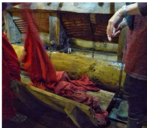
Här ser man tyget när det tas upp ur hon för översyn. De "randiga" träbitarna i bakgrunden är stamparna, som går växelvis upp och ner och under tiden föser tygrullen, som ligger i hon under, runt. Tyget är blött och man håller på vatten under tiden också, varmt eller kallt. Tyget bearbetas i stampen 20-30 minuter per omgång.
