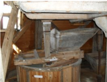
3) Gröpkvarn. Användes till malning av djurfoder.
