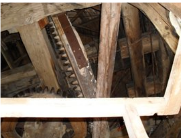
4) Krongreppet som sitter på spindeln. Spindeln går ner till Stjärnhjulet som driver kvarnarna.
