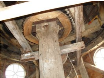
5) Detta är kronhjulet som sitter på den axeln som driver krongreppet.
