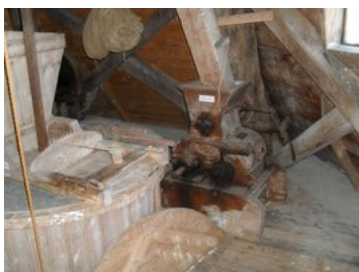
6) Krossen som användes till att krossa säden till djurfoder.
